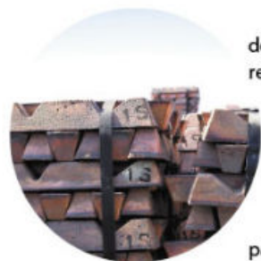
Figura 4.46 Las manchas oscuras formadas sobre las barras de cobre es el óxido producido al reaccionar éste con el oxígeno del aire.
