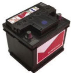
Figura 4.4 En el interior de una batería de automóvil hay celdas que contienen ácido sulfúrico, el cual funciona como electrólito.
