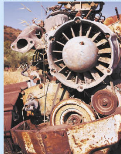
Figura 4.64 La corrosión deteriora los materiales y en ocasiones los deja totalmente destruidos, como este tractor.
