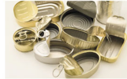
Figura 2.76 El estaño se usa para revestir el interior de las latas de alimentos.
