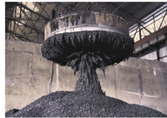
Figura 1.59 Además de metales ferrosos, mediante la magnetización es posible separar níquel y cobalto de otros materiales.
