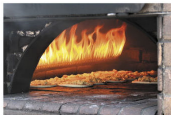
Figura 2.103 Los ladrillos de óxido de magnesio ( \text{MgO} ), al ser refractarios, se utilizan para recubrir hornos.
