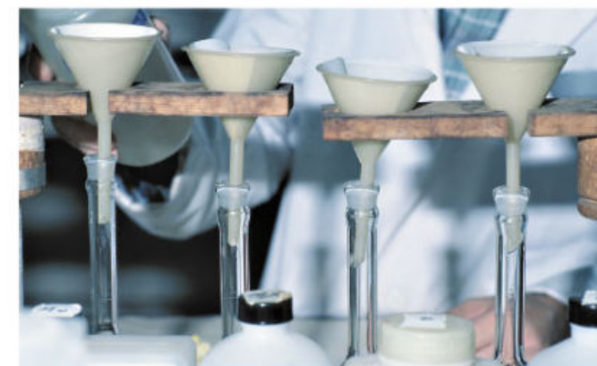
Figura 1.56 En las filtraciones es posible usar materiales porosos, como papel filtro, tela, cerámica o plástico, según el tamaño de las partículas.
