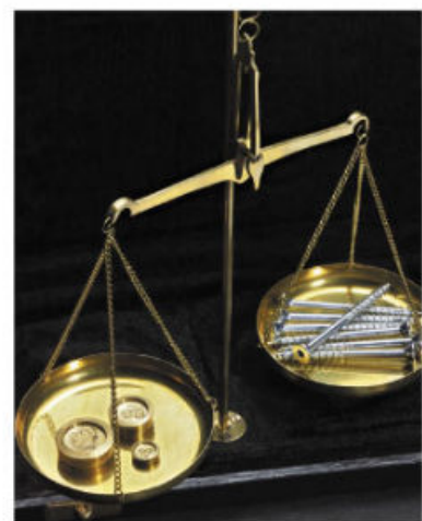
Figura 1.24 Con una balanza se compara la masa del cuerpo que nos interesa medir con la del que consideramos como referencia.
