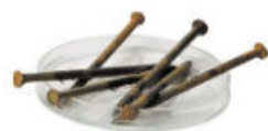
Figura 4.70 Aunque son varias las sustancias que producen el cambio que se ve en los clavos de la imagen, en todos los casos se trata de un fenómeno de oxidación.
