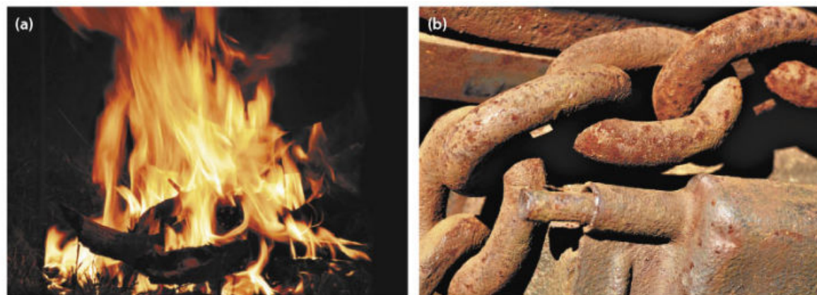
Figura 4.43 Una oxidación rápida, como la combustión, libera gran cantidad de energía calórica y luminosa (a). En el hierro, la oxidación lenta se lleva a cabo al estar en contacto durante mucho tiempo con el oxígeno del aire o con el agua (b).
