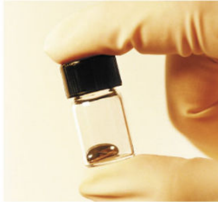
Figura 2.40 A temperatura ambiente, el mercurio es un líquido blanco plateado y brillante, que normalmente se ha utilizado en termómetros y en algunos interruptores eléctricos.
